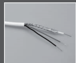
EC-1000R Kombinationskabel mit 1 x Video 75 Ohm und 2 x Draht 0,6 mm. PVC-Mantel weiß, für Videosignal und DC-Spannung.
