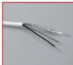
EC-1000R Systemkabel Kombinationskabel mit 1 x Videoleitung 75 Ohm und 2 x Draht 0,6 mm für Verbindung einer CCTV-Kamera mit Spannung und Videosignal.
