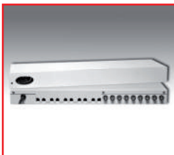
EP-1209 Netzgerät mit 9 x Spannungs- und 9 x Videoausgang für max. 9 Kameras. Video-Ausgänge über 9 x BNC. Tischgerät über 19"-Haltewinkel ( 1 HE ). Ausgang: 12,9 V/DC - 4A.
