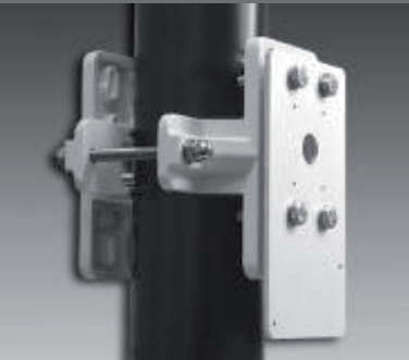
EMS-104 MASTMONTAGE-HALTERUNG Mastschelle mit Montageplatte und Schraubensatz für die Befestigung der Kamera-Wandhalterung EMW 104 an Masten mit 50-150 mm Durchmesser.
